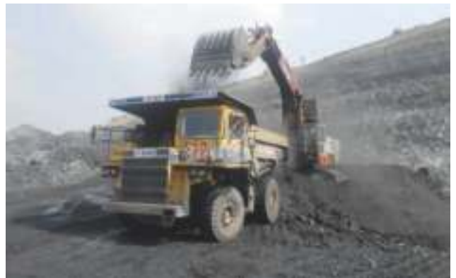
चित्र6.10: कोयले की खान डम्पर एवं फावड़ो के मेल से चलती है।
